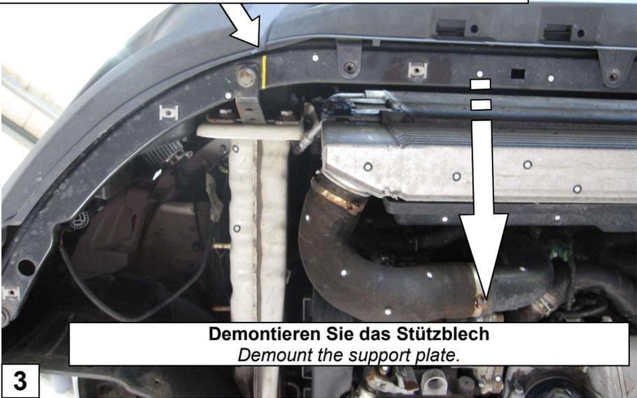
**Demontieren Sie das Stützblech**
