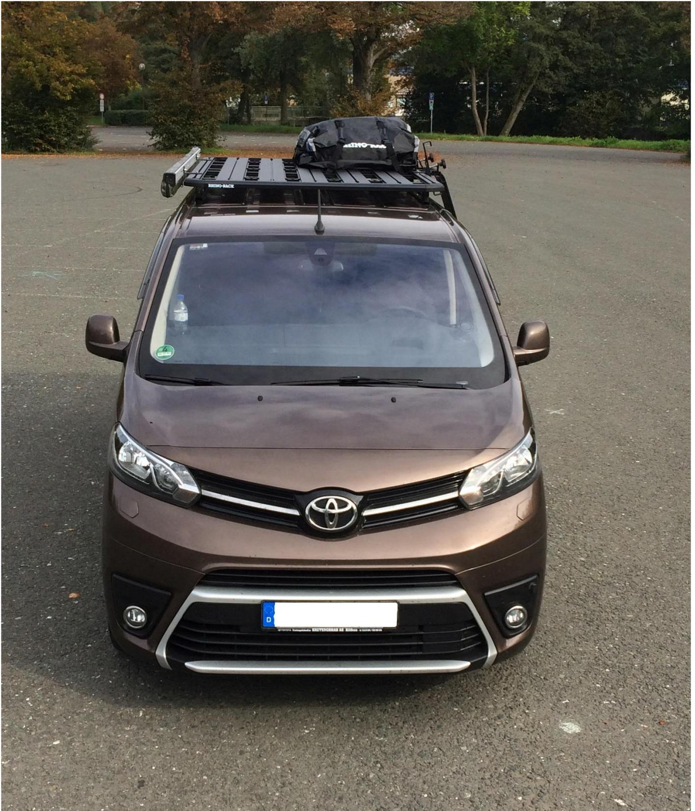
Das Problem bei Fahrzeugen mit Heckklappe ist, das diese nur Befestigungspunkte für Dachträger im vorderen Dachbereich haben, mit einem Abstand von maximal 70 cm. Somit ist der Transport von langen Gütern, wie Leitern, Rohre etc. ausgeschlossen. Aber auch Campingfreunde, die vielleicht eine Dachplattform für Ihr Equipment oder eine Markise an der Seite montieren möchten mussten bis jetzt passen.
